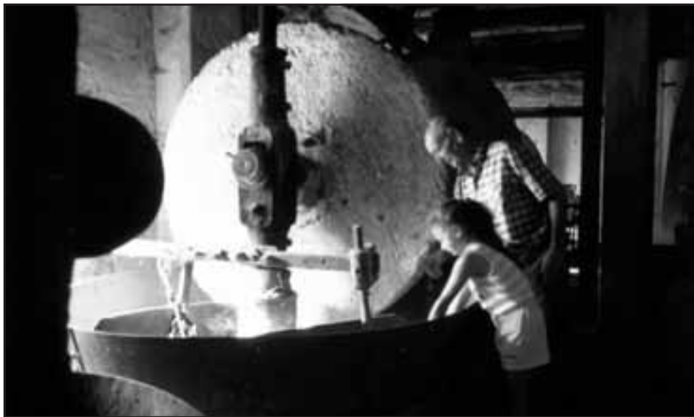
L'ex mugnaio Luigi Pizzamiglio dinanzi a una colossale molazza in granito, una delle cinque ancora esistenti alla cascina Molinazzo di Mediglia. Serviva a sminuzzare la scorza di cui sono rivestiti i chicchi di riso, scorza utilizzata per l'alimentazione animale.
