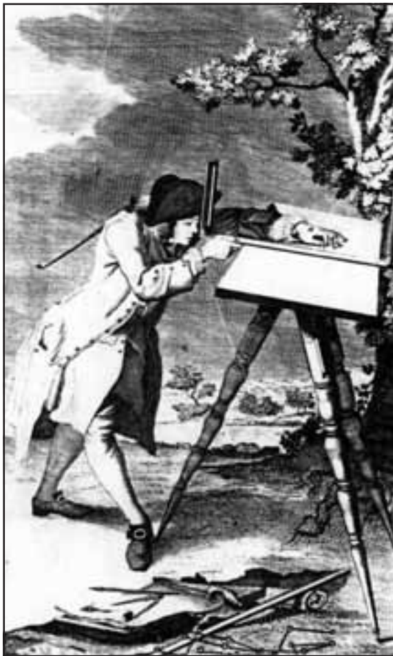
Misuratore catastale con tavoletta pretoriana e diversi strumenti mentre traccia la mappa di campagna (da G.G. Marinoni, De Re ichnographica , Vienna, 1751). Di questi tecnici si servivano lo Stato e i Comuni per realizzare le mappe topografiche, utilizzate anche a fini fiscali.
